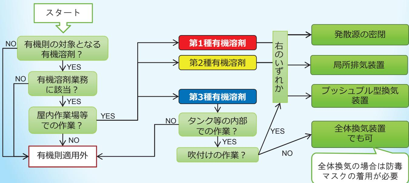
屋内作業場等において有機溶剤業務に労働者を従事させるとときは、その作業場所に有機溶剤の蒸気の発散源を密閉する設備、局所排気装置、プッシュプル型換気装置等を設けなければなりません。
