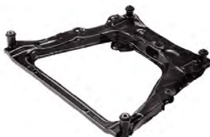
フロントサスペンションメンバー：車体を支える骨格。強さと軽さが求められる。
