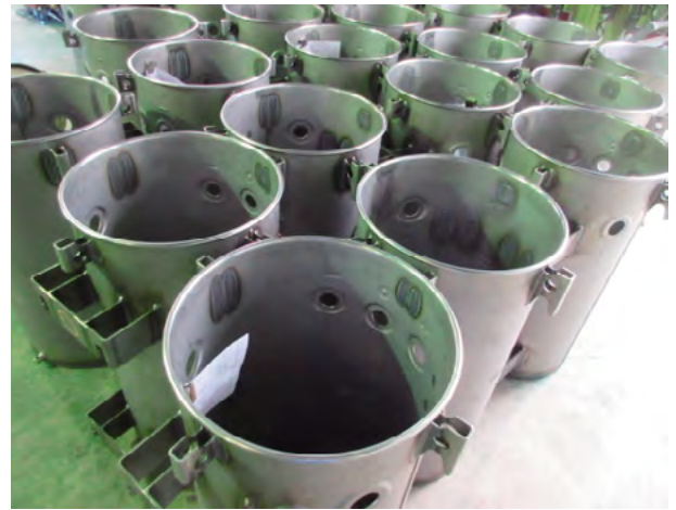
同社の製品（左：エレベーター用プーリー、右：柱上変圧器ケース）
