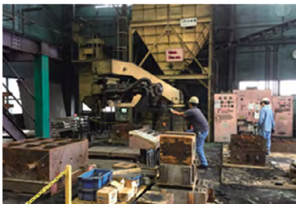
油圧シリンダ付アームがついたミキサーによる作業
